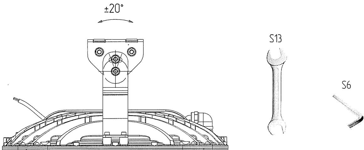
Ослабив гайку (поз.7), отрегулировать угол поворота светильника вокруг своей оси.
