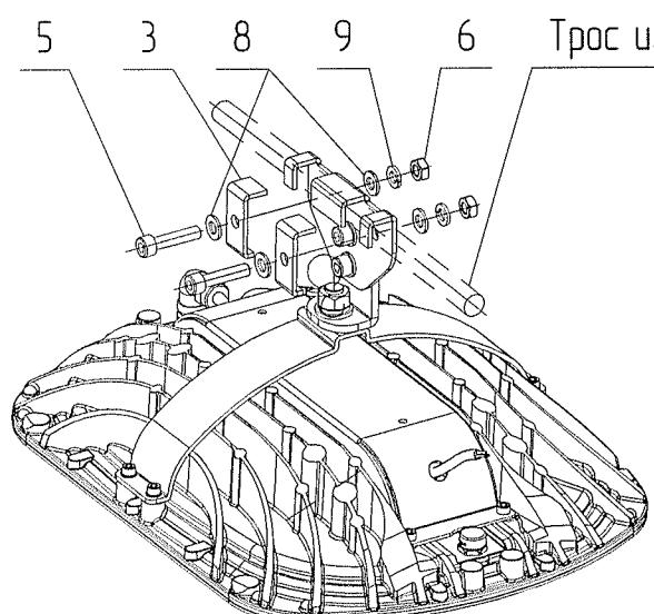
3. Разместить светильник на тросе. Задфиксировать кронштейн на тросе, установив и затянув прижимы. Использовать гаечный ключ S=13мм и шестигранный ключ S=6 мм. Подключить силовой кабель.
